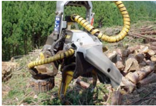
マーキングによる仕分け機能がついたハーベスタのヘッド
